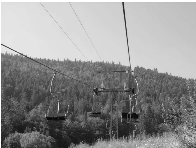
Abbildung 58: Sesselbahn Buttes-La Robella, die letzte noch existente fix geklemmte Sesselbahn im Schweizer Juragebirge.
